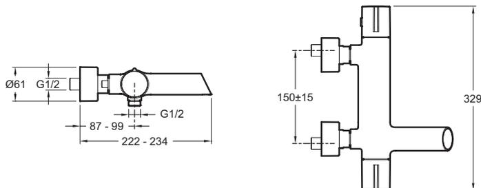
Спецификация продукта: Термостатический настенный смеситель для ванны/душа. E8992. Коллекция: TOOVI. ВЕС: 3,2 кг. ТИП УСТАНОВКИ: Крепление к стене. ТИП: Термостатический. РАСХОД ВОДЫ: 19 л/мин. ПОДКЛЮЧЕНИЕ: С настенными крепежами и кольцами. МЕХАНИЗМ: Термостатический картридж. РАЗМЕТКА ОТВЕРСТИЙ: 150 ± 15 мм. СЛИВ: 0. ОДНОРЫЧАЖНЫЙ СМЕСИТЕЛЬ: ТЕРМОСТАТИЧЕСКИЙ ОДНОРЫЧАЖНЫЙ СМЕСИТЕЛЬ. УСТАНОВКА: Настенные. ГАРАНТИЯ НА ОТДЕЛКУ: 10 лет.
